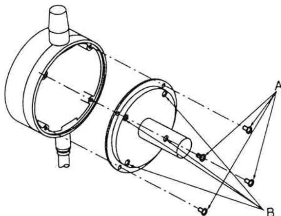
Dévissez les quatre vis de fixation du dos identifiées sur la figure ci-contre par le repère A (Réf. 02ACB411), puis retirez le dos du comparateur et remplacez-le par le dos approprié. Fixez ce dernier à l'aide des quatre vis précédemment retirées.
