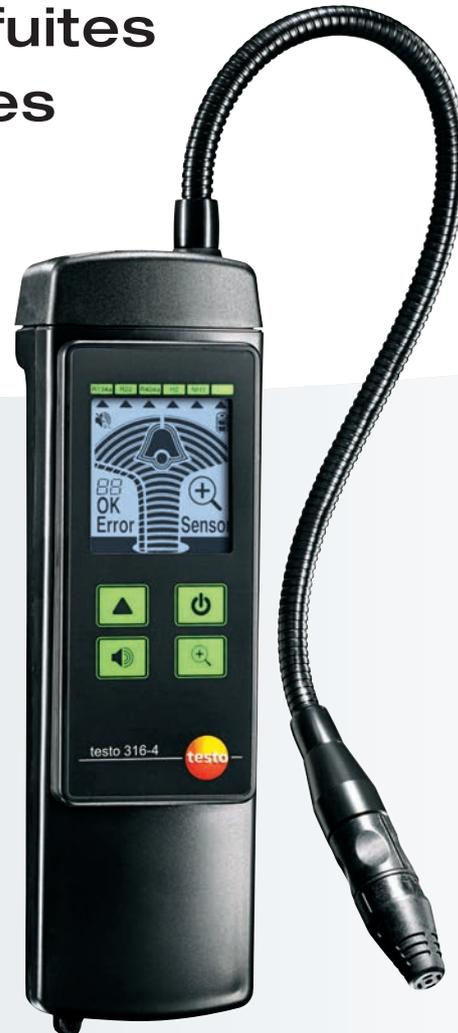
Le testo 316-4 (kit 1) est un détecteur de fuites rapide et fiable pour tous les fluides frigorigènes courants. Le capteur est contrôlé en permanence et affiche tout dysfonctionnement ou encrassement à l'écran. Le recours à des fuites-tests devient ainsi inutile. En cas d'encrassement, le capteur peut aisément être remplacé et est à nouveau immédiatement utilisable.
